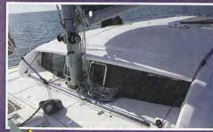
Pas pratique Il manque une marche pour accéder au toit de la nacelle... et des poches à drisses au pied du mât.
