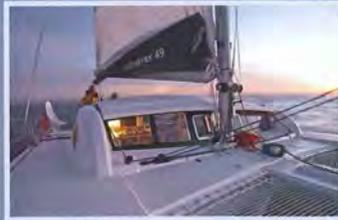
Les hublots frontaux sont presque verticaux et coiffés d'une courte casquette pour éviter l'effet de serre. Le rail du solent autovireur est habilement intégré au rouf: il ne gêne pas du tout la circulation.
