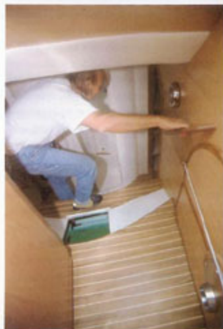
La faible hauteur sous barrot et les marches étroites des descentes aux flotteurs ne plairont pas à tout le monde.
